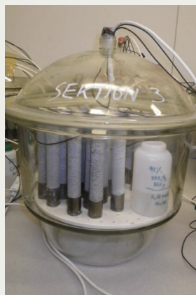
Figur 2. Tillverkade prover där armering är ingjuten i bruk med olika kloridkoncentrationer som exponeras i olika relativa fuktigheter.
